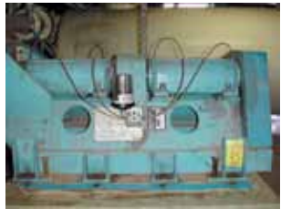
MEMOLUB® kot centralni sistem mazanja
