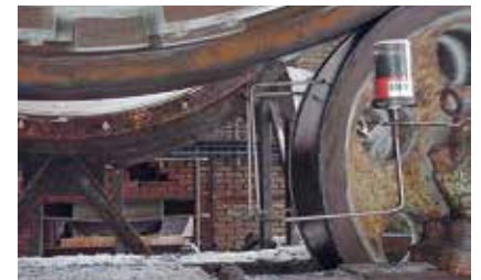
MEMOLUB® s mašču za otvorene zupčanike
