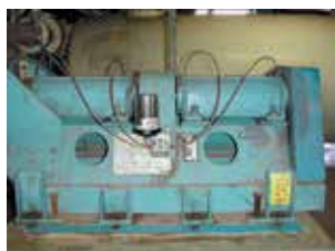
MEMOLUB® kao centralni sistem podmazivanja
